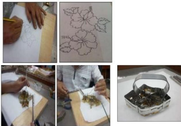
Rajah1: Proses pembuatan blok batik tradisional oleh adiguru blok batik
