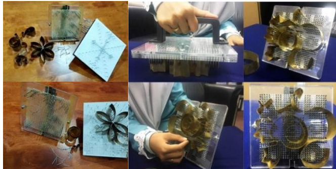
Rajah 6: Proses selitan kepingan logam di ruang antara paku-paku bagi menghasilkan kesan garis seperti blok batik tradisional
